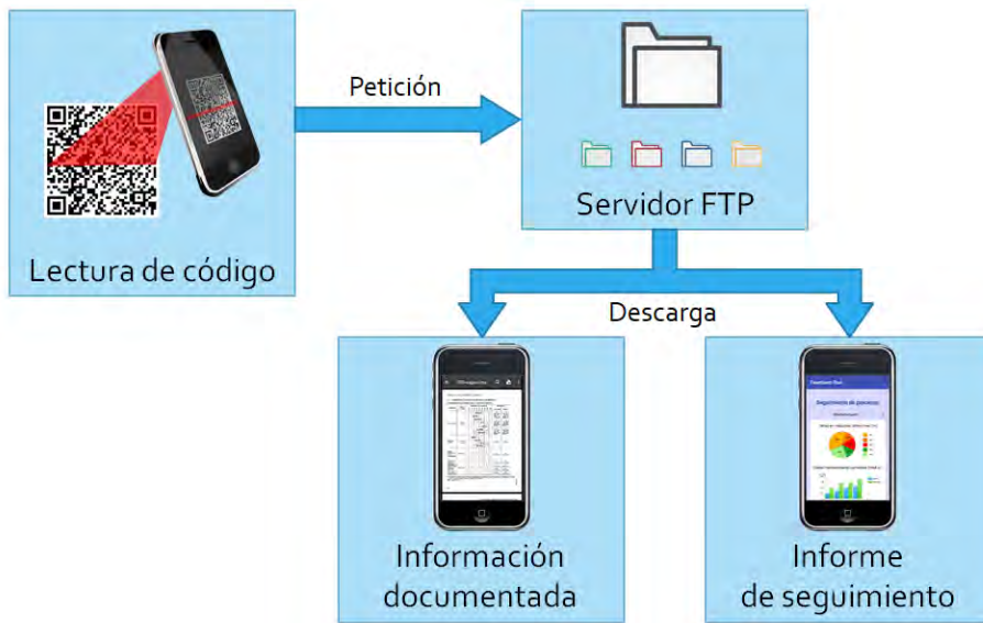
Fig. 6. Esquema del funcionamiento del sistema. La lectura de cualquier código QR desde la aplicación, produce una petición al servidor para descargar la documentación adecuada.
