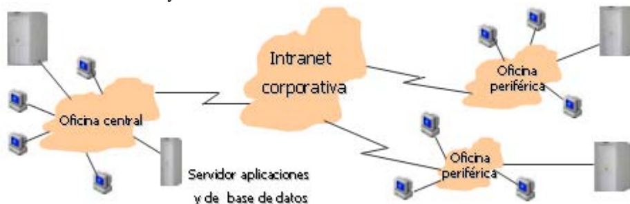
Fig. 1. Esquema de la red existente para nuestra entidad. En la oficina central se incluye el servidor de aplicaciones y de base de datos que atenderá las peticiones de los usuarios de los diferentes centros que componen la misma.
