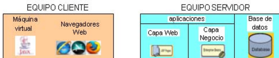
Fig. 2. Se simplifica el software del equipo cliente a máquina virtual java y navegador Web que en este caso será Internet Explorer. En el equipo servidor, una aplicación Java EE y una base de datos derby, deberán satisfacer las peticiones del cliente.
